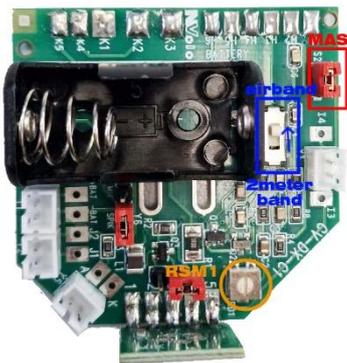
Dans les écouteurs à double système radio, l'écouteur droit dispose d'une autre carte qui a exactement les mêmes réglages que celui de gauche, afin que les deux radios puissent être réglées de façon indépendante.
